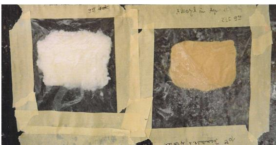
Probeflächen zur Gipskrustenreduzierung mit Ionenaustauscherharz-
