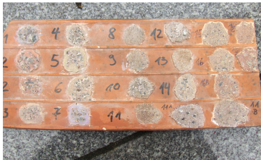
Probekplatte zu den getesteten Mörtelrezepturen
