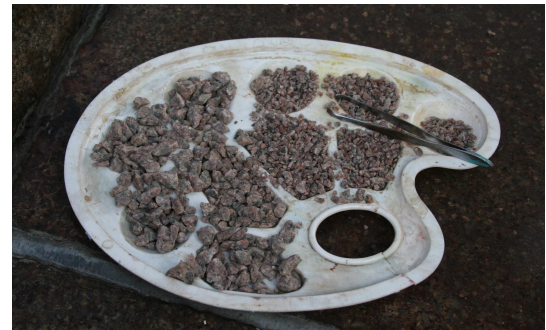
Granit-Zuschlagfraktionen für den Ergänzungsmörtel
