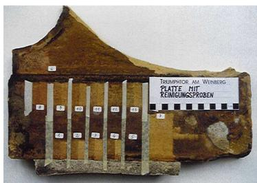
Probeplatte für die Reinigungsversuche
